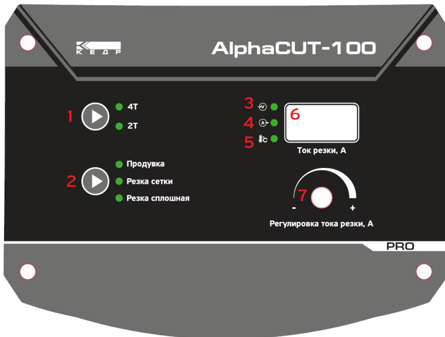
1. Кнопка выбора режима 2Т/4Т работы кнопки плазмоторна;
